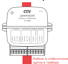
Рисунок 5 – Монтаж модуля сопряжения
