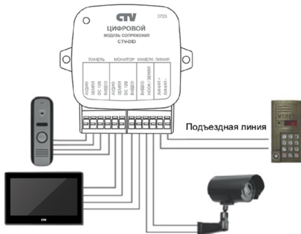
Рисунок 4 – Подключение компонентов домофонной системы
